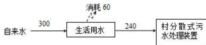
图2-1建设项目水量平衡图（单位：t/a）
